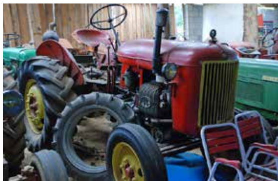
Une curiosité mécanique parmi beaucoup d'autres : tracteur MAP (Manufacture d'armes de Paris). Moteur diesel 2 temps, bicylindre horizontal transversal à 4 pistons opposés. Puissance 30 CV à 1500 tours/mn.
